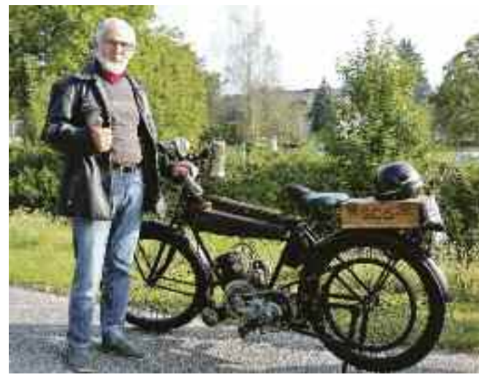
Martin Naderer aus Windhaag bei Perg war einer der „Stars“ beim Moped-Treffen. Seine französische „Terrot“, Baujahr 1926, zog die Blicke der Zuseher auf sich. Das 175 ccm-Motorrad bringt 3,5 PS auf die Straße und erlaubt eine Höchstgeschwindigkeit von 70 km/h.
